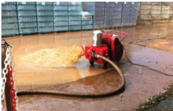
Motopompa in azione per svuotare Cantina Fattori a Terrossa
