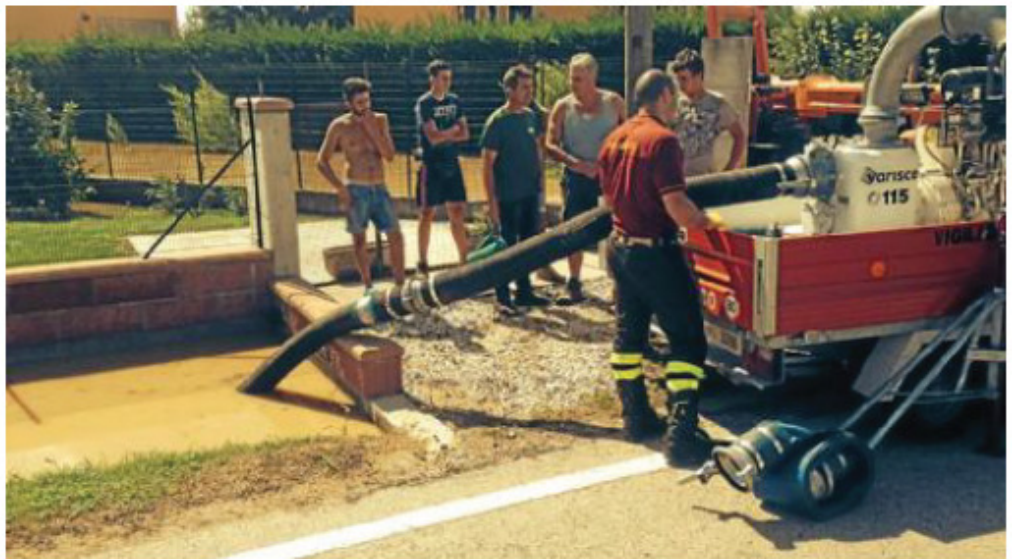
L'intervento dei vigili del fuoco di Lonigo per svuotare con l'idrovora i fossati. FOTO BUSATO
