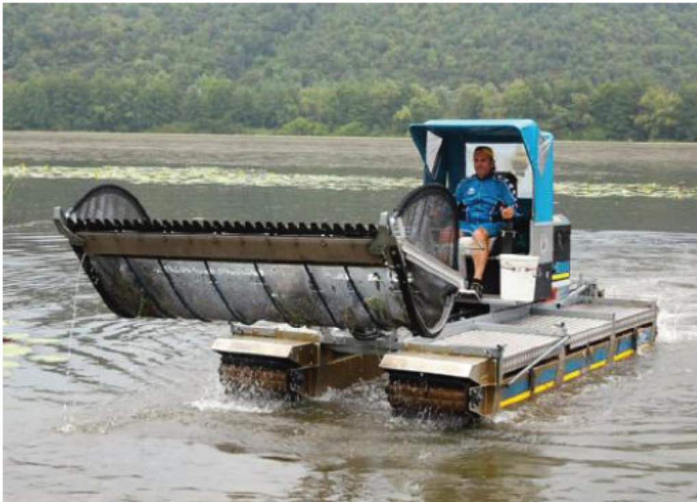
La sperimentazione del mezzo anfibio per la pulizia del lago di Fimon infestato dalle alghe
