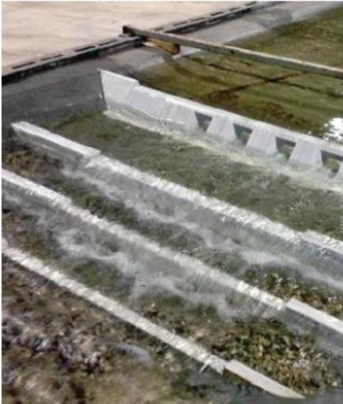
Un particolare del modello che replica l'invaso in scala 1:40. L.N.
