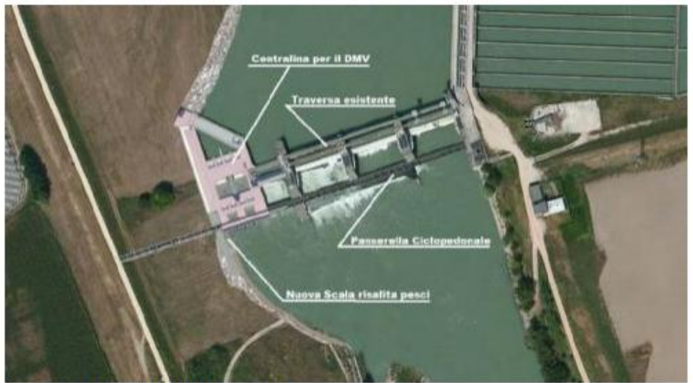
Il progetto della mini centrale elettrica sull'Adige
