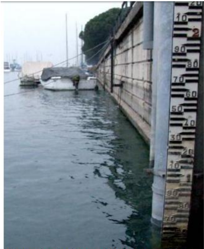
L'idrometro che a Peschiera segnala il livello delle acque del Garda
